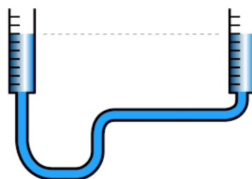
у будівництві – шланговий рівень
