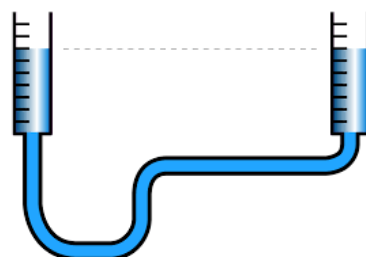
ve stavebnictví – hadicová vodováha
